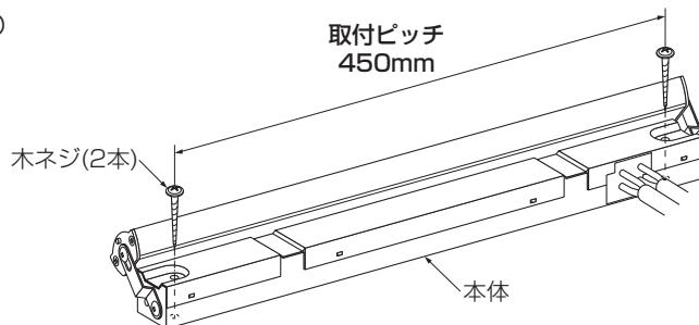
※壁面取付けの場合、横長付け・縦長付けのどちらでも取付可能です。
