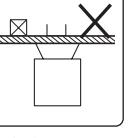
補強のない取付面</p> |
