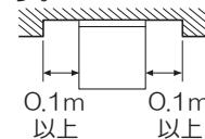
取付面(天井・壁)が上図寸法以上平らなところに取付けてください。
