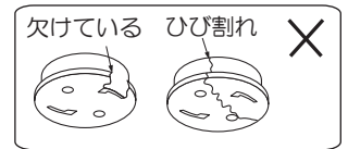
破損しているもの
