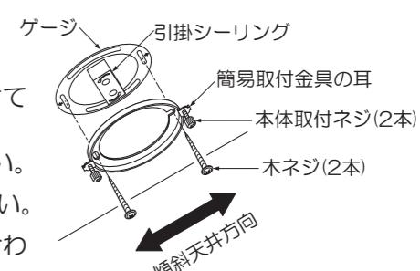
●引掛けシーリングに、簡易取付金具に付属のゲージを合わせ、天井面に貼り付けてください。
