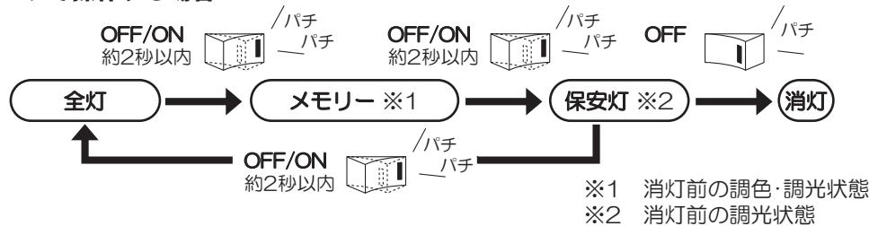
※壁スイッチをOFFにしてから約3秒以上経過した後、再度ONにすると消灯前の状態に戻ります。
