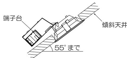
本体を取外す場合は、枠をゆっくり引き下げ、取付バネ(2本)を両手でせばめながら取外す。
