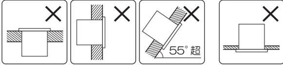
床面 壁面 指定以外の 補強のないロックウール 傾斜天井 等のやわらかい天井
