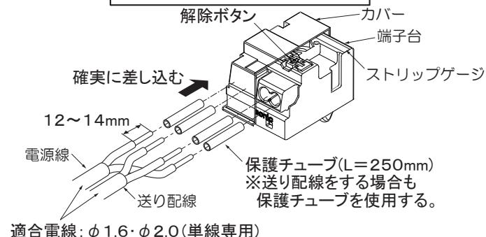
電源線を取り外す場合は、マイナスドライバー等で解除ボタンを押しながら、電源線を引き抜く。
