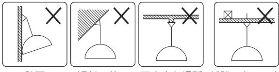
器具に荷重をかけたり、布や紙等の可燃物で覆わないでください。器具の真下にストーブ等の温度の高くなるものを置かないでください。火災・感電・落下の原因となります。
