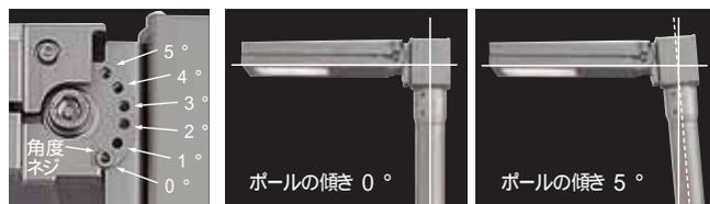
0° ~ 5° に対応するネジ穴を角度ネジで固定してください。 灯具下面を水平に保つよう微調整できます。
