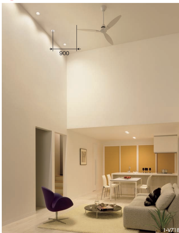
ファンから離してダウンライトを設置することで影とチラツキを軽減。
